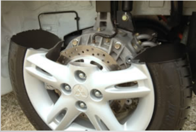
iMiev'in tekerlek yerleşimli motor ünitesi
