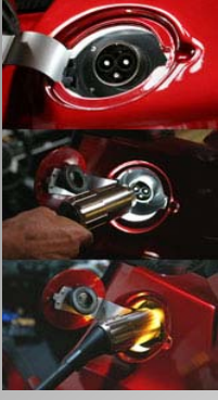
Tesla roadster'in benzin depo kapağı yerindeki şarj soketi
